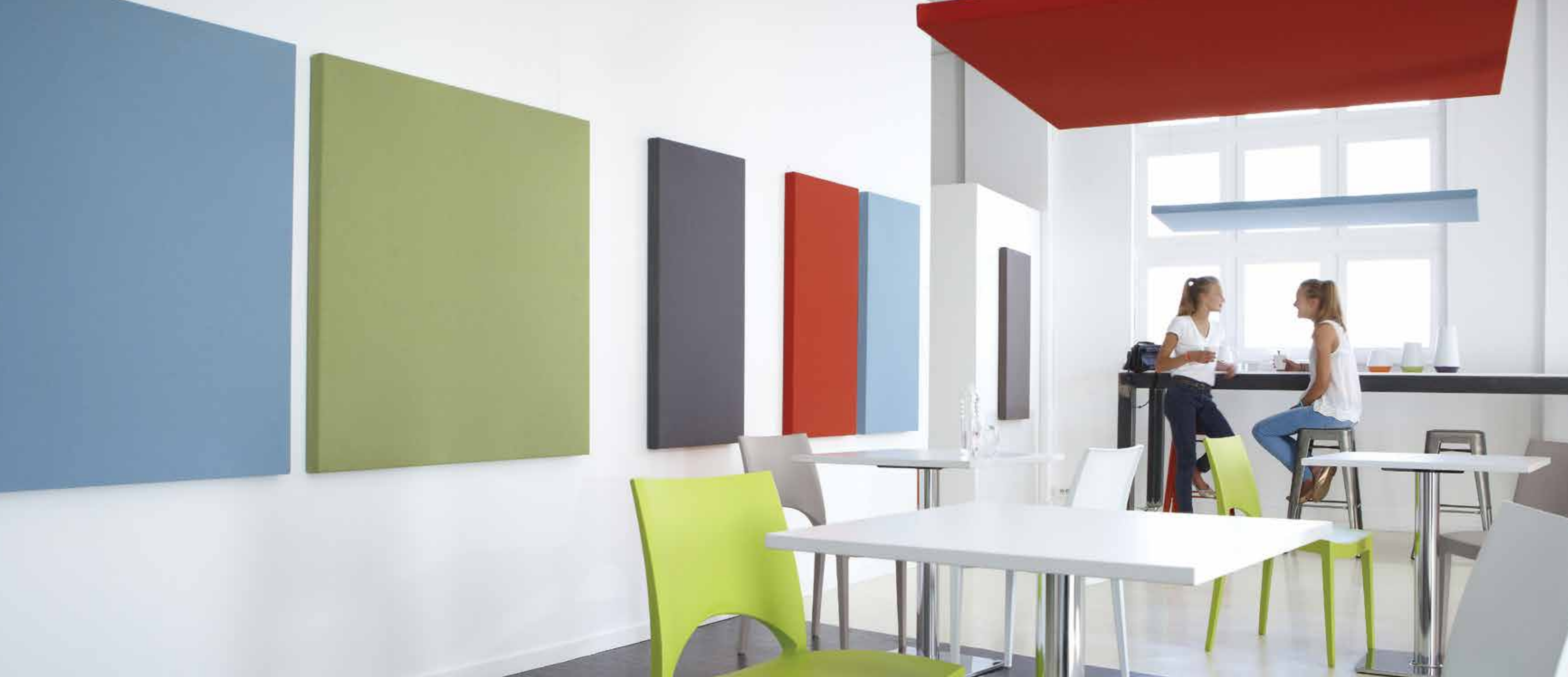
Panneaux acoustiques (collection MAYE) 120 x 120 cm / 60 x 120 cm fixés par système aimanté au mur et par système de suspension horizontale
